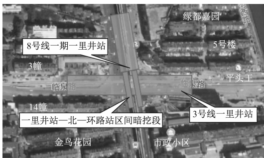
图1 8号线一里井站与既有3号线一里井站的平面位置关系图
