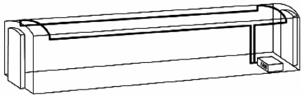
图 2 感应线圈在地铁客室内的布置示意图
