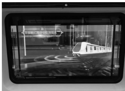
图3 新型地铁列车侧面车窗 OLED 显示屏
