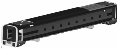
图 2 车体有限元模型 Fig. 2 Finite element model of carbody
