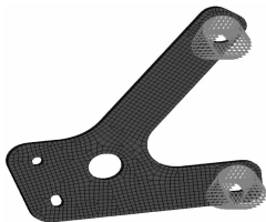
图 2 线缆支架有限元模型 Fig. 2 Finite element model of cable bracket
