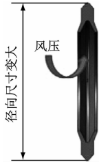
图 5 K 形圈受压膨胀密封原理示意图
