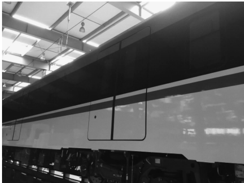
图9 门板腰线分色喷涂试验效果
