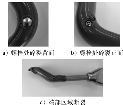
图1 扶手吊碎裂照片
