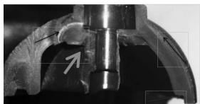
图7 螺栓紧固力矩过大裂纹实景图
