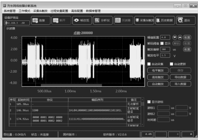
图 6 故障 A 车的三级网络 波形截图
