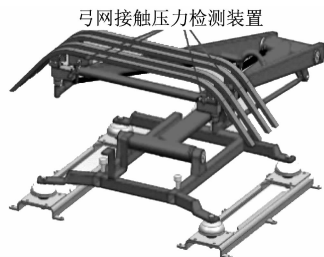
图7 弓网接触压力检测装置安装示意图
