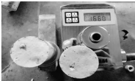
图4 黏结性试验试件的破坏面
