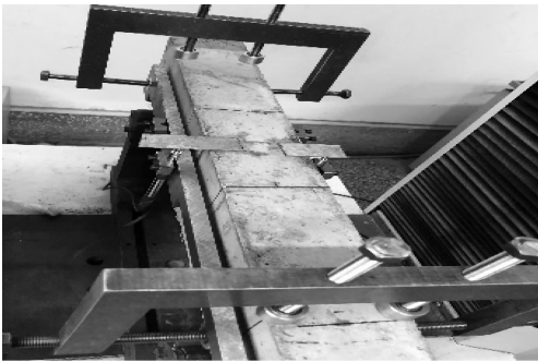
图 2 弯曲梁试验装置
