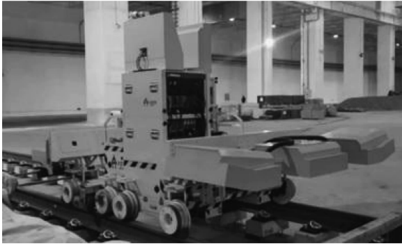
图3 综合巡检机器人的定制化装配
