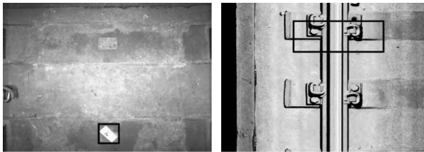
a) 道床异物病害 b) 扣件系统病害
