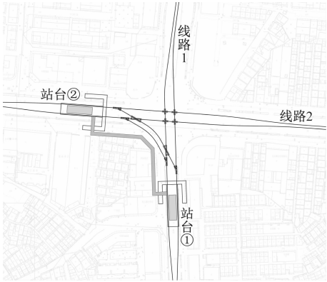
图 8 车站及联络通道布置示意图(西南象限双向互通为例)
