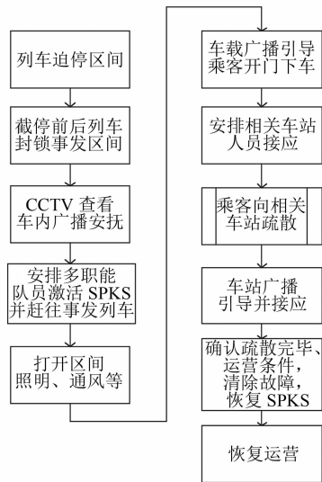
图 6 远程引导区间疏散基本事件流程
