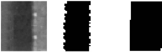
a) 原图 b) 二值化图像 c) 5 像素 × 5 像素模板腐蚀
