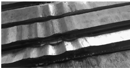
图2 碳滑板磨耗不均和烧灼实物图
