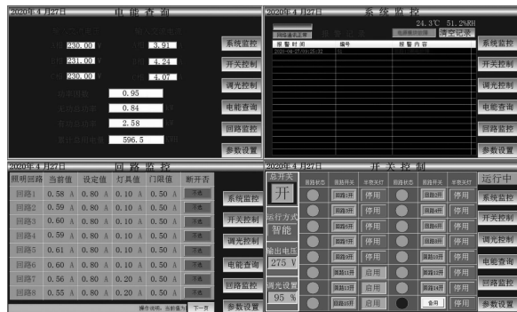
图 6 直流集中照明供电系统的人机交互界面截图
