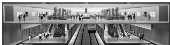
图3 四线双岛站台建筑信息模型横截面示意图
