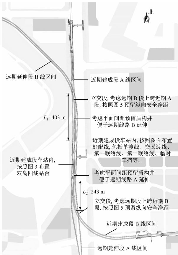
图6 推荐地铁线路拆解方法工程实例示意图
