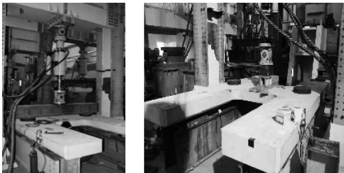
a) 纵梁加载试验 b) 横梁加载试验
