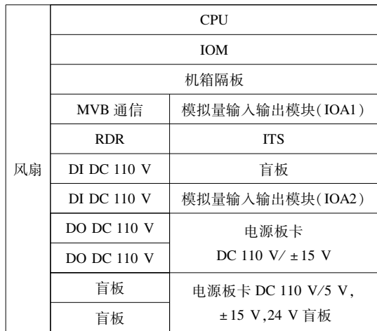
注:ITS 为温度采集模块;DI 为数字量输入;DO 为数字量输出。 图 2 高压控制单元硬件布局图
