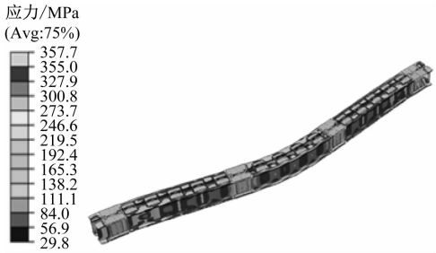
a) 绕虚轴失稳应力云图
