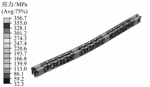
b) 支撑绕实轴屈曲应力云图
