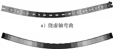
图3 双H型钢支撑屈曲模式
