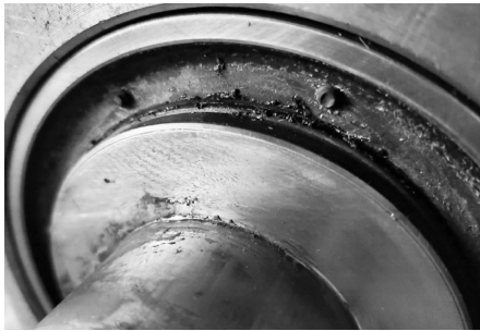
图2 转臂节点疲劳试验后的外观状态
