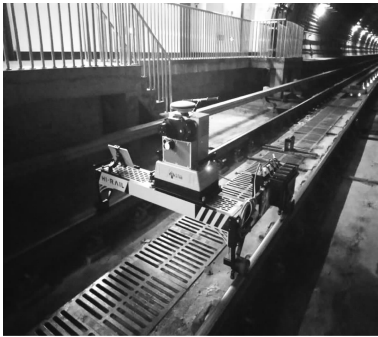
图 6 武汉某地铁盾构隧道管片环面错台现场检测图
