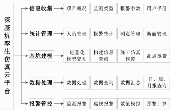
图 1 深基坑孪生仿真云平台系统的主要功能
