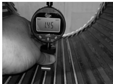
图 8 槽楔切痕深度测量照片
