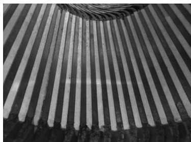
图 11 退槽楔后定子状态
