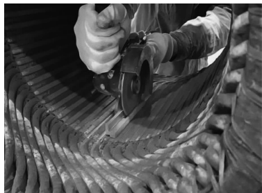
图 9 槽楔切割照片
