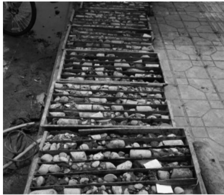
图1 局部地勘钻孔岩心取样
