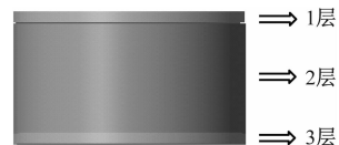
图 1 Al-50% Si 合金试样结构示意图
