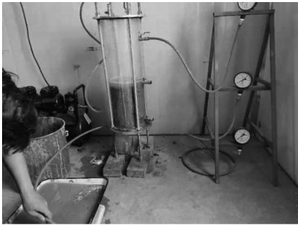
图 10 自制变水头渗透仪
