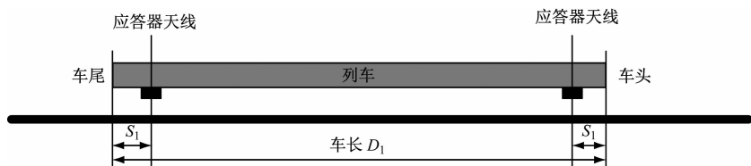
图 1 车载应答器天线安装位置示意图
