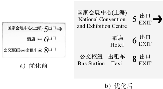
图 4 出站引导标识结构形式优化设计图
