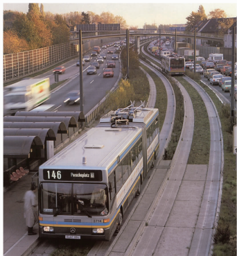
图 2 德国埃森市的导向巴士系统 Fig. 2 Guided bus system in Essen, Germany
