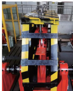
图 2 涡流制动试验装置实物图
