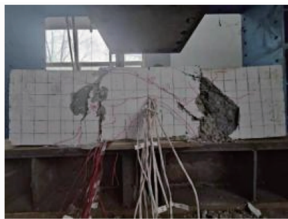
图 6 试件 JF-1 的破坏形态
