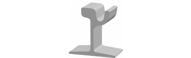
图 3 槽型轨道结构示意图 Fig. 3 Structure of the grooved track
