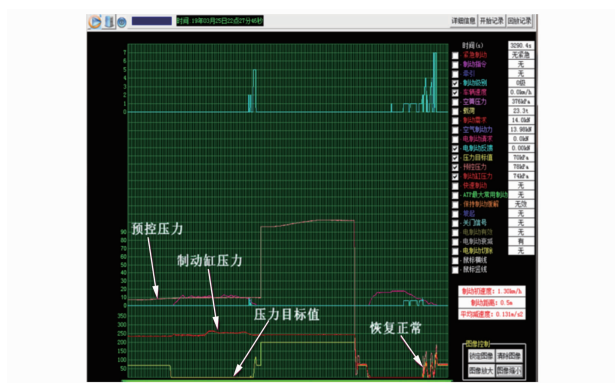
图 3 目标压力为 0、预控压力不为 0 的故障界面截图
