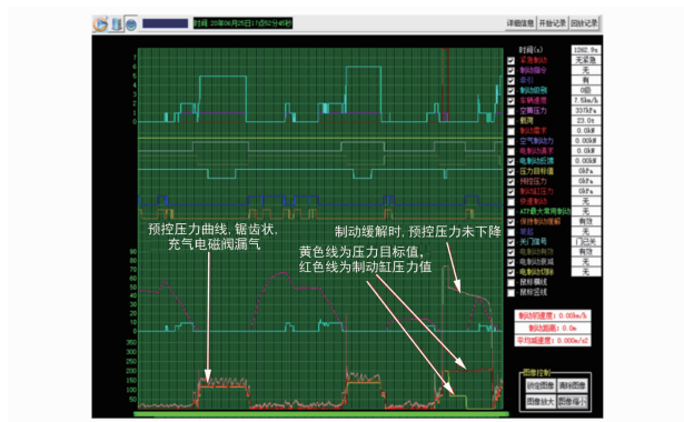
图 4 预控压力曲线成波齿状的故障界面截图
