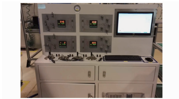
图 5 电磁阀阀体检测台实物图
