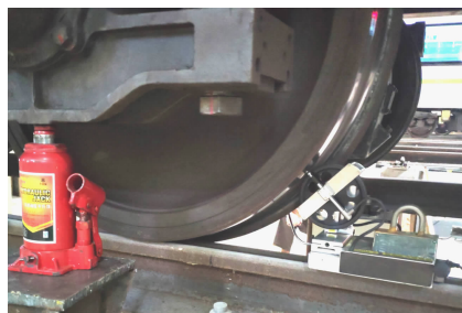
图 2 车轮不圆度现场测试照片
