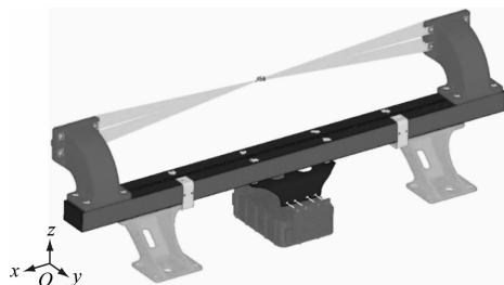
图2 天线支架有限元模型
