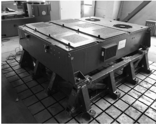
图7 空调机组和测试工装实景图
