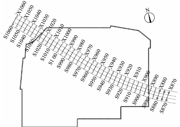
图 4 地铁下行线隧道结构监测点平面布置图 Fig. 4 Layout of monitoring point of metro down line tunnel structure
