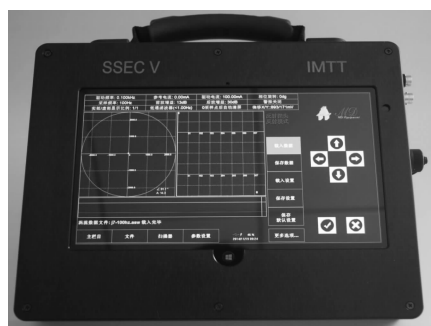
图2 SSEC V型远场涡流仪照片
