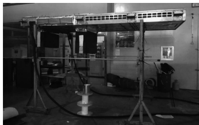
图2 空调声功率测试现场实景图
