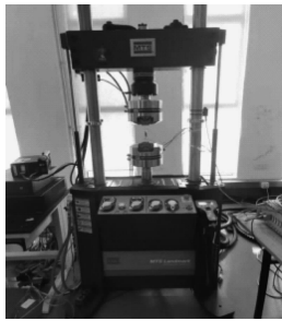
图3 MTS 810 电液伺服材料试验机
