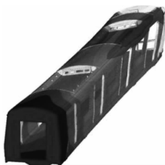
图 2 一阶菱形振型(车体铝结构)
