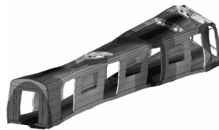
图 4 一阶扭弯振型(车体铝结构)
