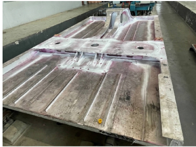
图 15 台架试验的端部底架试件实景图
