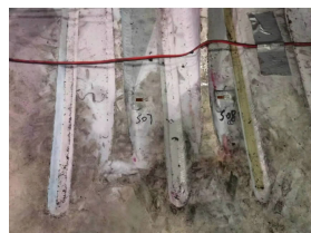
c) S7、S8 测点贴片实景图
