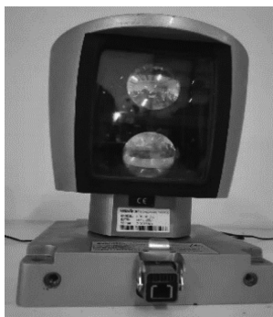
图1 HDL-64E 型车载式激光雷达实物图
