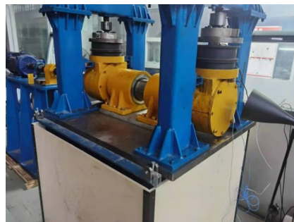
图5 高速列车滚动轴承试验台照片
