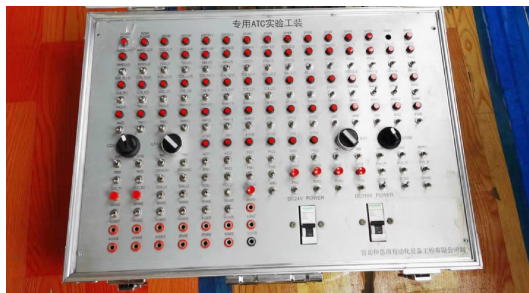
图5 信号系统测试工装设备照片
