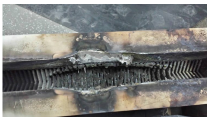
图6 直流快速断路器烧损照片
