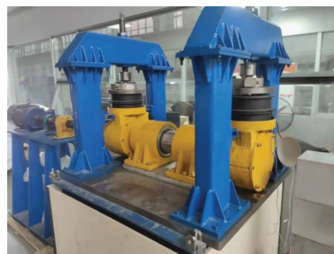
图 10 轴箱轴承试验台照片
