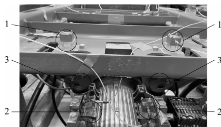
a) 模态试验传感器布置全图
