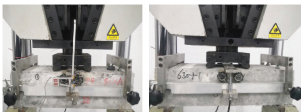
a) 正面(夹式)传感器 b) 反面(伸缩式)传感器
